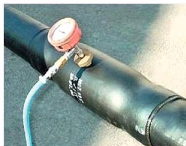
**4.5.14.** Контроль герметичности производится опрессовкой, после остывания муфты до температуры 40 С.
